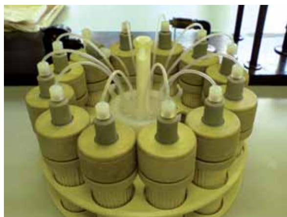
Sl. 3 Rotirajuća ploča s 12 teflonskih posuda mikrovalnog uređaja Fig. 3 Rotation plate with 12 teflon vessels of the microwave oven
